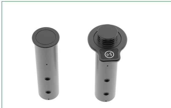
VIS-BDY-F 是一款嵌入安装的麦克风, 并可在无需使用时, 让麦克风在桌面消失。这是通过简单地向下按下麦克风的顶部直至其锁定来实现的。然后再按一下麦克风, 麦克风将升回到桌子表面上方的原始位置。该麦克风可以通过 VIS-AIB 模拟麦克风连接盒接入到 CLEACON 全数字网络会议系统中使用, 也可以连接到模拟系统中使用, 如 VIS-FS100-A 全自动反馈抑制器, 混音器, 调音台, 音频矩阵等。
