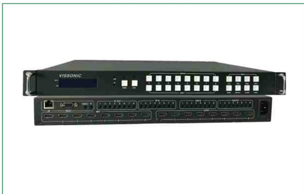
VIS-UHD0808-VW 8x8无缝超高清矩阵和视频墙处理器
