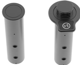
VIS-BDY-F 是一款嵌入安装的麦克风,并可在无需使用时,让麦克风在桌面消失。这是通过简单地向下按下麦克风的顶部直至其锁定来实现的。然后再按一下麦克风,麦克风将升回到桌子表面上方的原始位置。该麦克风可以通过VIS-AIB模拟麦克风连接盒接入到CLEACON全数字网络会议系统中使用,也可以连接到模拟系统中使用,如VIS-FS100-A全自动反馈抑制器,混音器,调音台,音频矩阵等。
